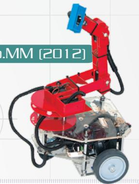
Cada llanta se puede mover a diferente velocidad para girar o avanzar en distintas direcciones.
